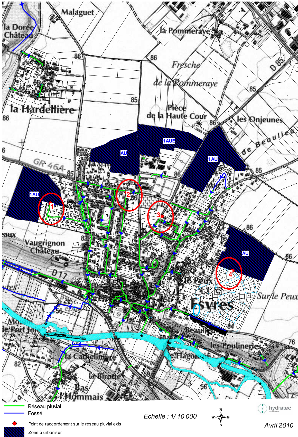
Figure 9 : Localisation des futures zones à urbaniser et leur potentiel point de raccordement sur le réseau pluvial existant
